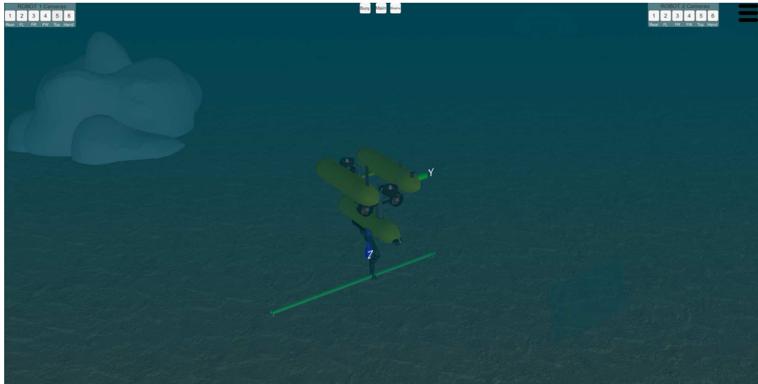
Figura 10: Contacto con la tubería: Vista Superior
