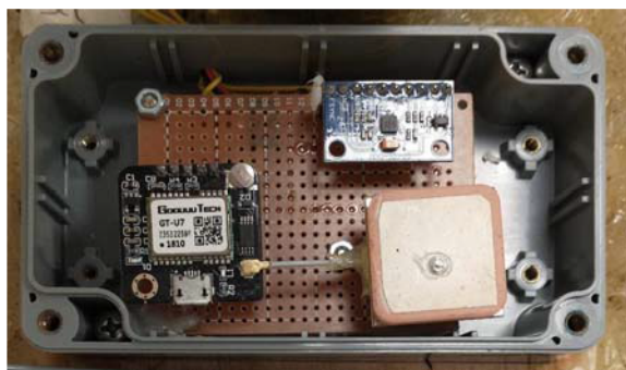
Figura 12: Detalle del GPS, su antena y el magnetómetro
