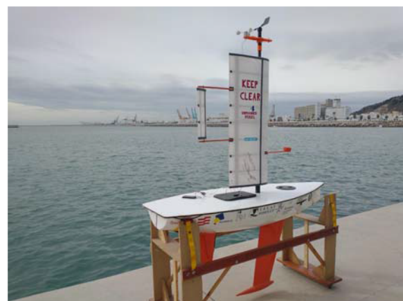
Figura 1: Velero autónomo Sensailor
