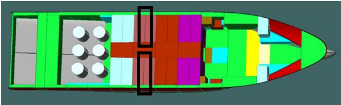
Mamparos corrugados intermedios de los tanques de barro de perforación
