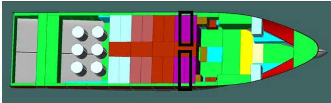
Mamparos corrugados intermedios de los tanques de salmuera
