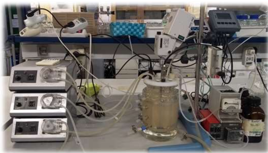
Figura 2.4. Diseño del reactor SBR aerobio para la selección de cepas acumuladoras de PHA. De izquierda a derecha: bombas peristálticas de sustrato (abajo), nutrientes (en medio) y vaciado (arriba); cuba con agitador mecánico, sonda de pH y sonda de OD; bombas peristálticas para el control de la acidez (abajo) y de la alcalinidad (arriba).
