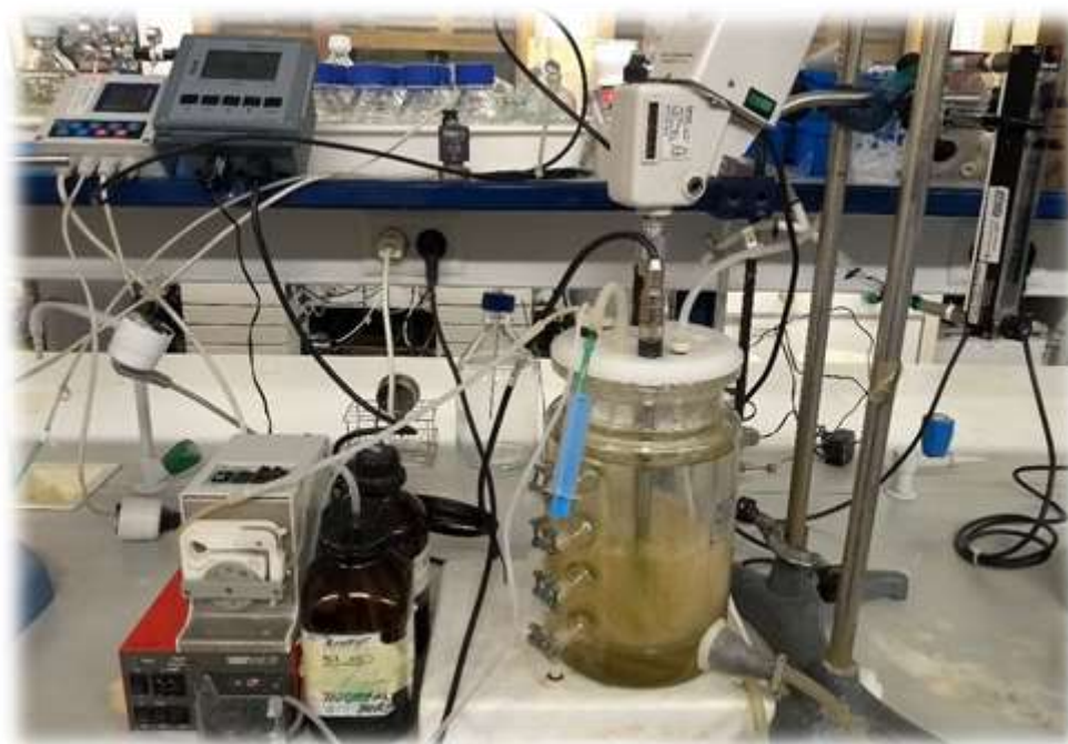
Figura 2.6. Diseño del reactor tipo fed-batch para maximizar la acumulación de PHA. De izquierda a derecha: bombas peristálticas para el control de la acidez (abajo) y alcalinidad (arriba) (parte inferior izquierda); reactor con las sondas de pH y OD y el agitador
