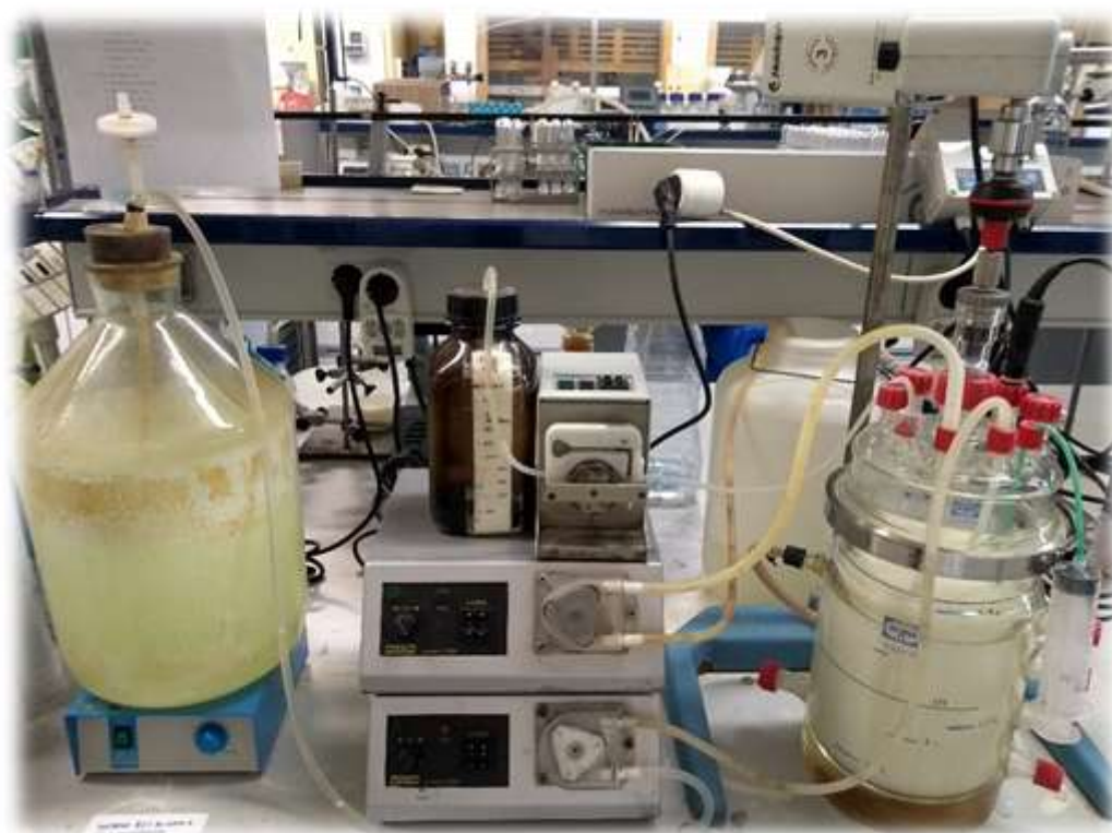
Figura 2.1. Diseño del AnSBR para el tratamiento anaerobio del suero lácteo con producción final de AGV. De izquierda a derecha: alimentación en garrafa de 10 L; bombas peristálticas de alimentación (abajo), vaciado (en medio) y control de pH (arriba); cuba y tapa del reactor con agitador mecánico y sonda de pH.
