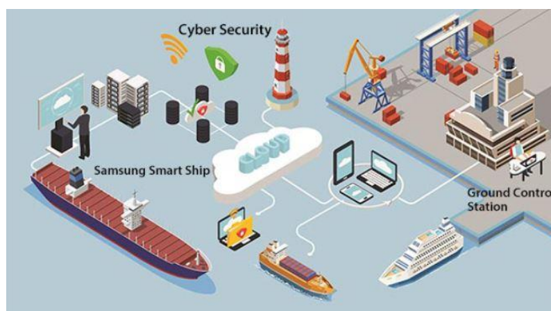
Figura 45. Ejemplo ilustrativo de un sistema de comunicación vertiendo los datos a una nube donde se almacenan y comparten por todos los equipos implicados en el tráfico marítimo. Los puertos realizan la función de nodo logístico controlando faros, rutas, servicios, etc.
