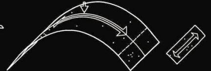
El mecanismo portante se basa, sobre todo, en la acción de arco (por ello en forma de catenaria). La acción de lámina es secundaria y sirve para transmitir cargas. O mecanismo portante permanece principalmente no efeito de arco (portante, forma catenária). O efeito de placa é menor e destina-se a receber cargas assimétricas.
