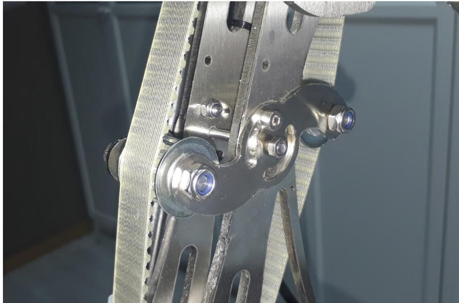
**Figura 13.24** – Detalle del tensor de la correa del antebrazo
