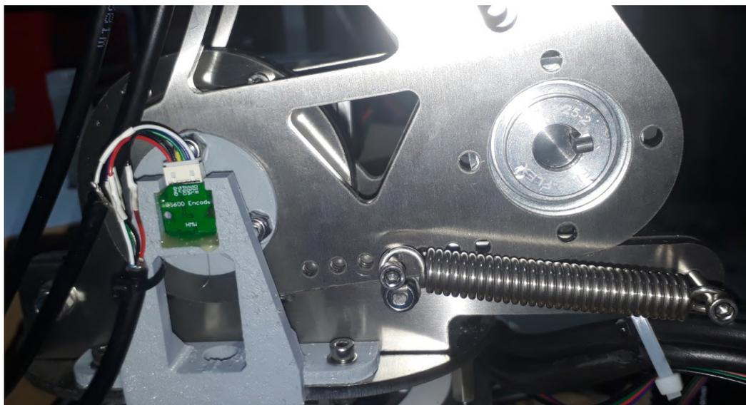
Figura 13.21 – Detalle del muelle y del encoder del hombro
