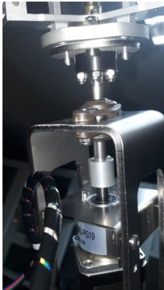
**Figura 13.25** – Detalle del montaje de la rotación de la muñeca
