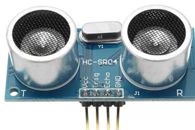
Figura 8.13 – Sensor de proximidad ultrasónico (Arduino)
