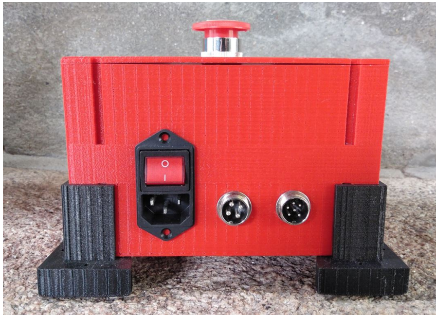
Figura 8.32 – Detalle de los conectores del depósito eléctrico
