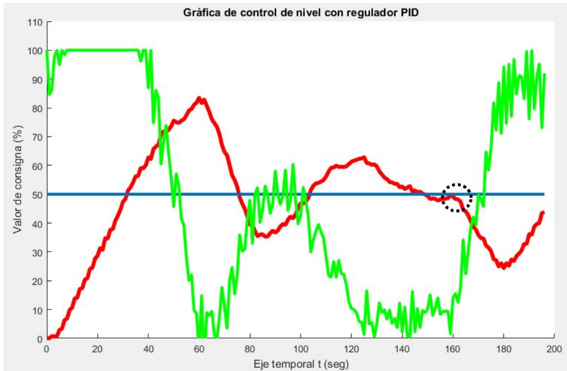
Figura 10.3 – Gráfica resultante del Controlador PID Discretizado
