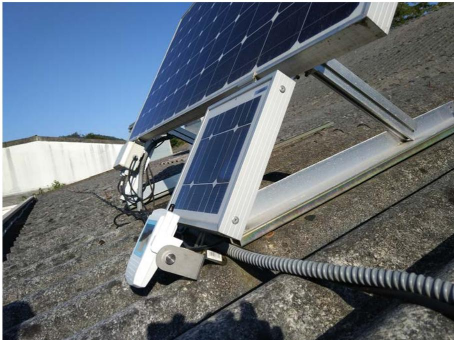
**Figura 7.11** – Colocación del radiómetro
