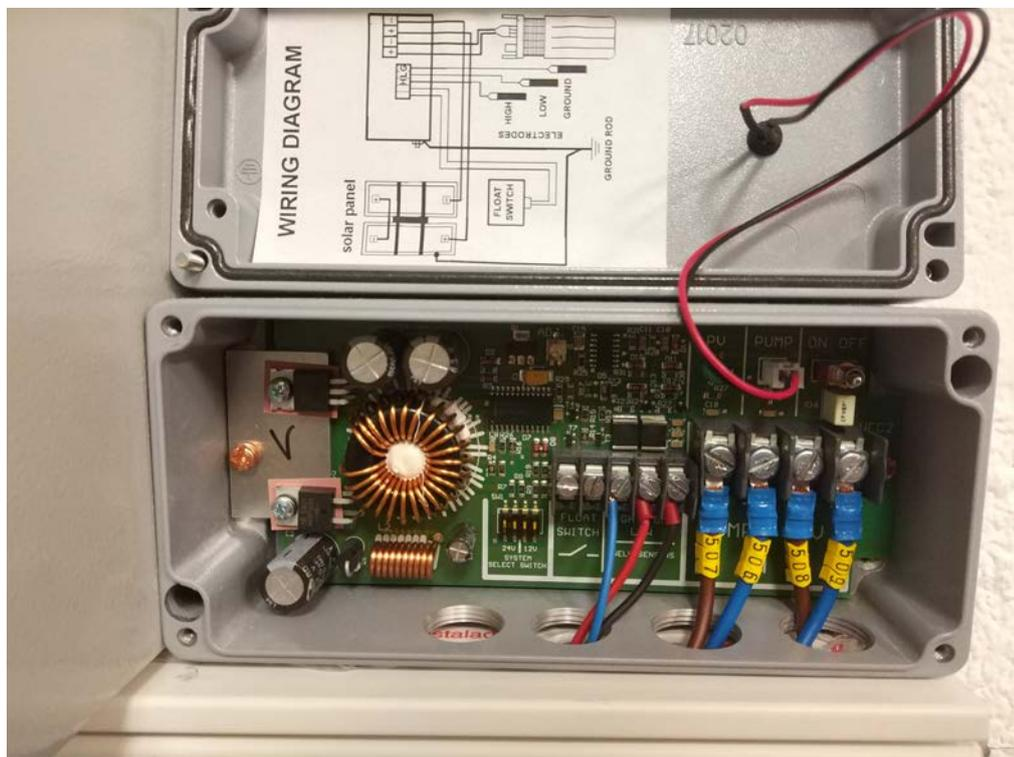
Figura 8.21 – Conexión del regulador
