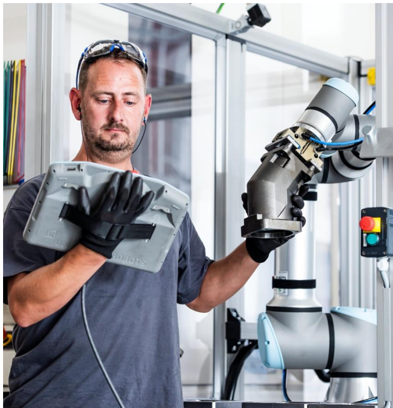
Ilustración 2: Cobot de Universal Robot. La pantalla táctil, permite su programación "in-situ". https://www.universal-robots.com/ .
