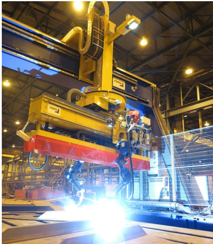
Ilustración 1: Robots de soldadura de PEMAMEK montados en un pórtico. https://pemamek.com/ .
