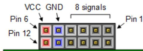
**Figura 11.1.0.2** – Numeración de los pines del puerto PMOD de la Nexys4 DDR.
