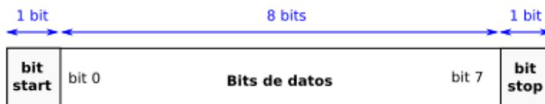
Figura 7.7.0.14 – Trama de datos de la comunicación mediante UART [18]
