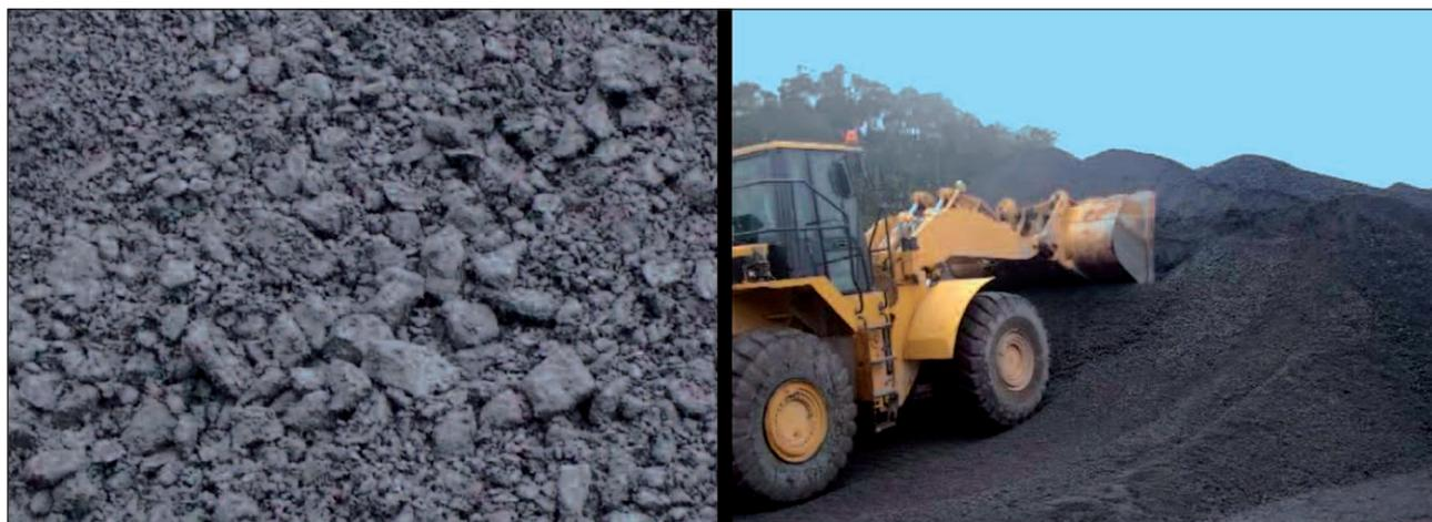
Figura 1. Aspecto en acopio del árido volcánico de litología basáltica y granulometría continua para capas de base granulares no tratadas
