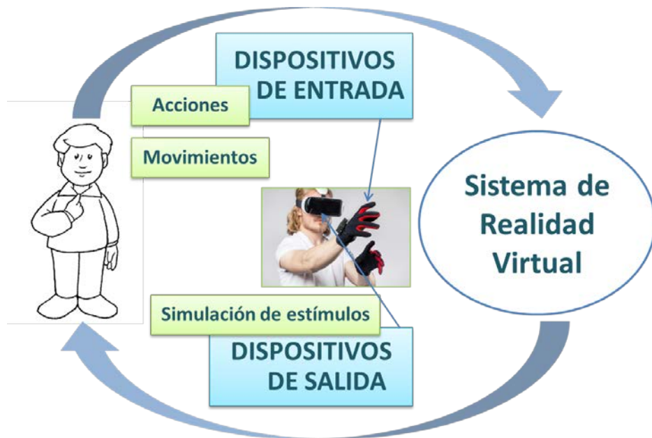
Figura 1.8. Relación entre el entorno de realidad virtual y el usuario. Los dispositivos de entrada permiten que las acciones y movimientos del sujeto se integren en el sistema de realidad virtual. Los dispositivos de salida proporcionan información al usuario de todo lo que sucede en el entorno de realidad virtual producto de la generación de estímulos por parte del ordenador, y de la interacción de las acciones del sujeto con dichos estímulos.
