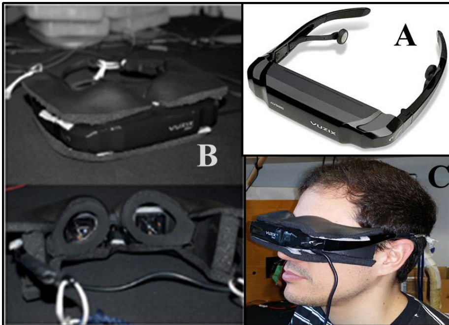
Figura 3.7. Gafas HMD para la inmersión en el entorno de realidad virtual. A) Modelo Vuzix iWear VR920. B) Adaptación de las gafas para el estudio mediante la colocación de espuma para garantizar un completo aislamiento del mundo real. C) Gafas colocadas en el sujeto.
