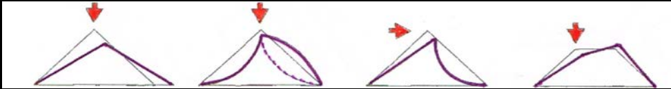
Desplazamiento de borde Abolladuras Abatimiento y abolladura Modificac. Ángulos
