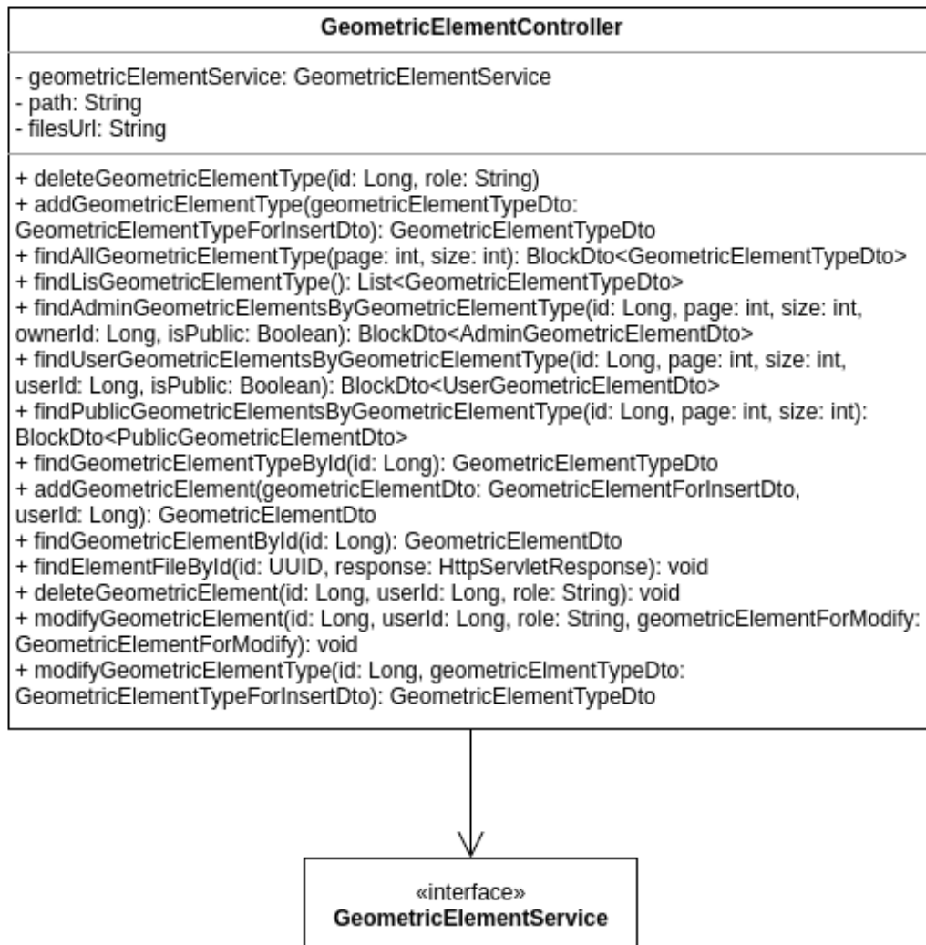
Figura 6.9. Diagrama do controlador GeometricElementController .
