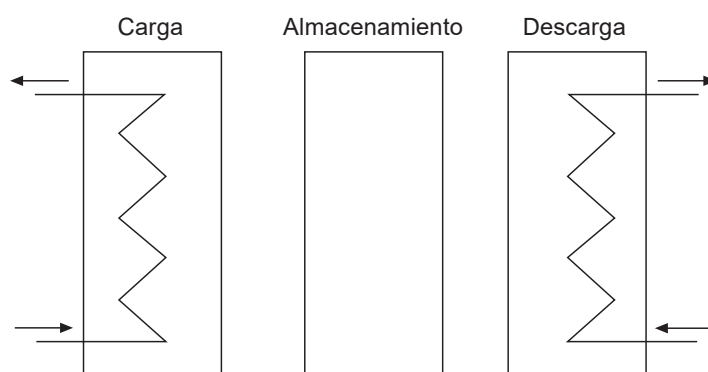
Figura 1.1: Ciclo completo de almacenamiento de energía en un sistema genérico. (Fuente: elaboración propia).
