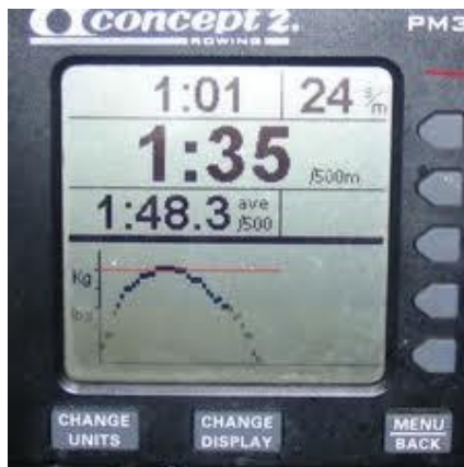
Ilustración 14. Curva de fuerza mostrada en pantalla del remo-ergómetro al remar en banco fijo.
