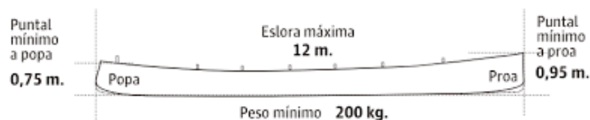
Ilustración 2. Medidas reglamentarias de una trainera.
