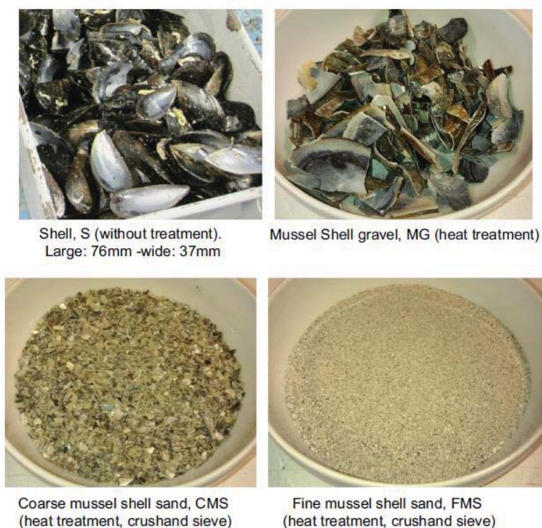
Figura 8. Diferentes etapas para la preparación del mejillón para su uso en bruto: concha lavada, concha tras tratamiento térmico y concha triturada a diferentes granulometrías 21
