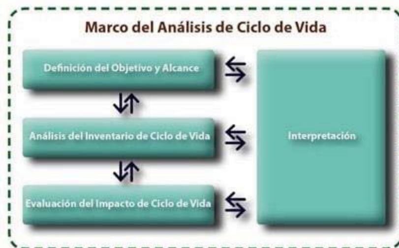
Figura 6: Estructura del ACV (Rodríguez, n.d.)
