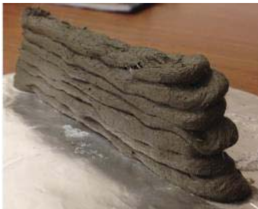
Figura 25: Deposición en capas do formigón mediante extrusión manual (37)
