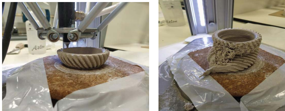
Figura 29: Probas Impresión 3D con cerámicas
