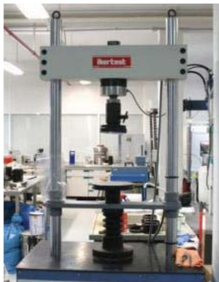
Figura 17: Prensa para ensaio de morteiro a resistencia mecánica (2)
