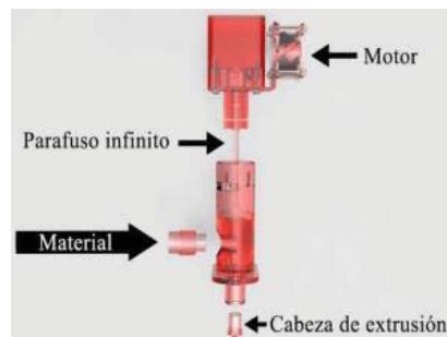
Figura 30: Detalle do extrusor, onde se ve a cabeza extrusora, para a Impresión 3D (28)
