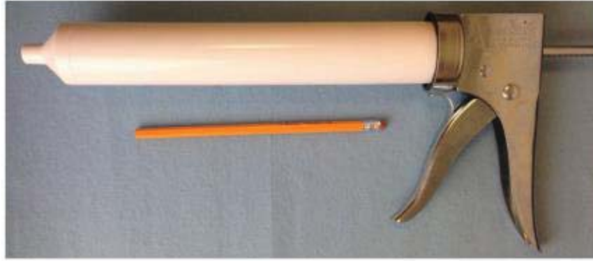
Figura 26: Extrusor manual para a impresión 3D (37)
