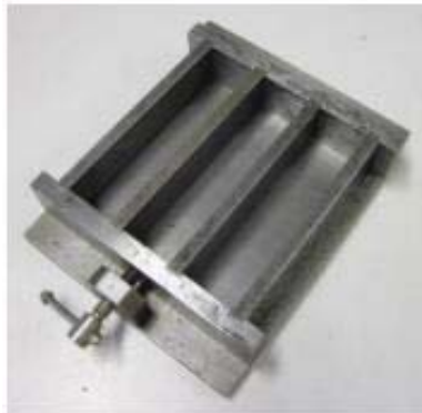
Figura 16: Molde para probetas 4x4x16 cm (2)
