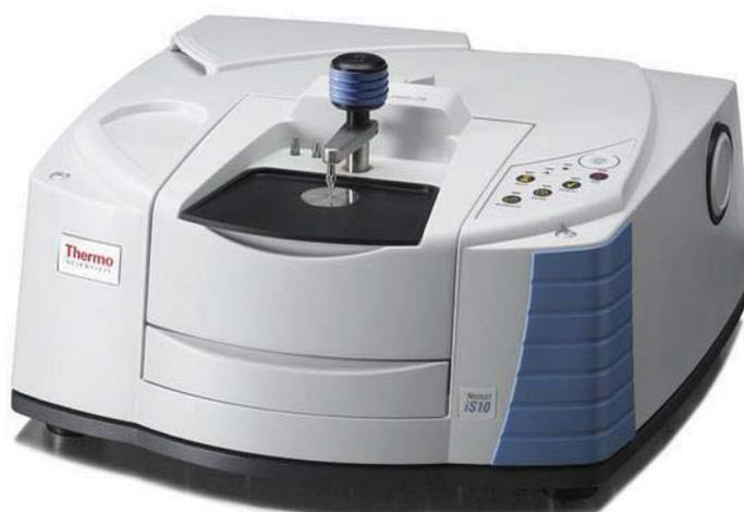
Figura 17: equipo de espectroscopia infrarroja con transformada de Fourier Thermo Scientific Nicolet is10. Obtenido de la página web del distribuidor<sup>48</sup>
