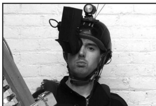
Figura 2.3: Primeiro prototipo de EyeTap
