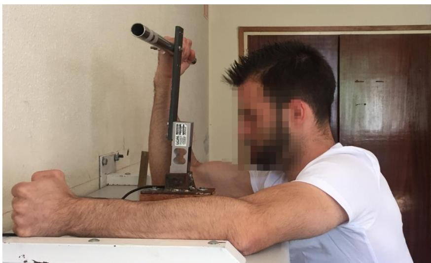
Figura 5. Dispositivo y posición para la contracción isométrica máxima
