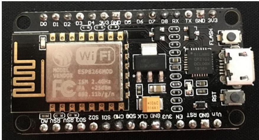
Figura 4.5: Módulo NodeMcu V3 Lua WiFi.
