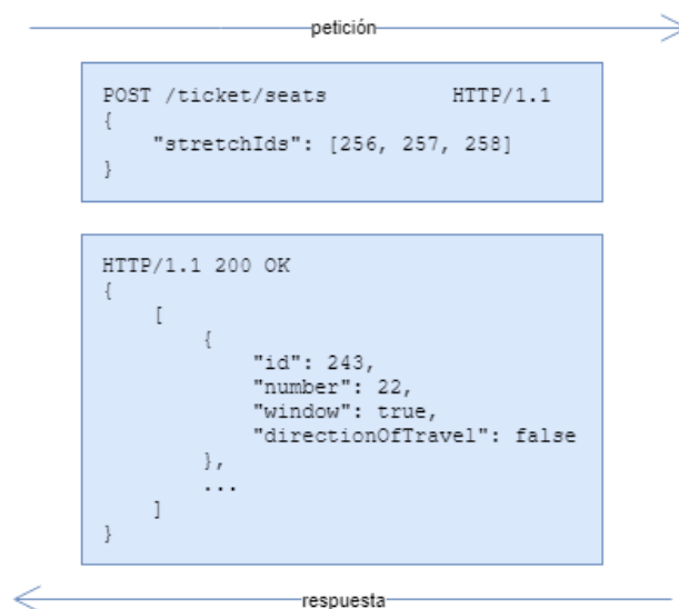
Figura 5.11: Petición y respuesta al invocar el método showFreeSeats de la capa de acceso a servicios
