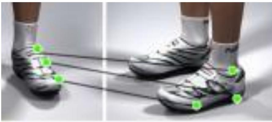
*Ilustración 7: Posicionamiento de los marcadores reflectantes en la zapatilla y tobillo del ciclista (Imagen adaptada de STT System).*
