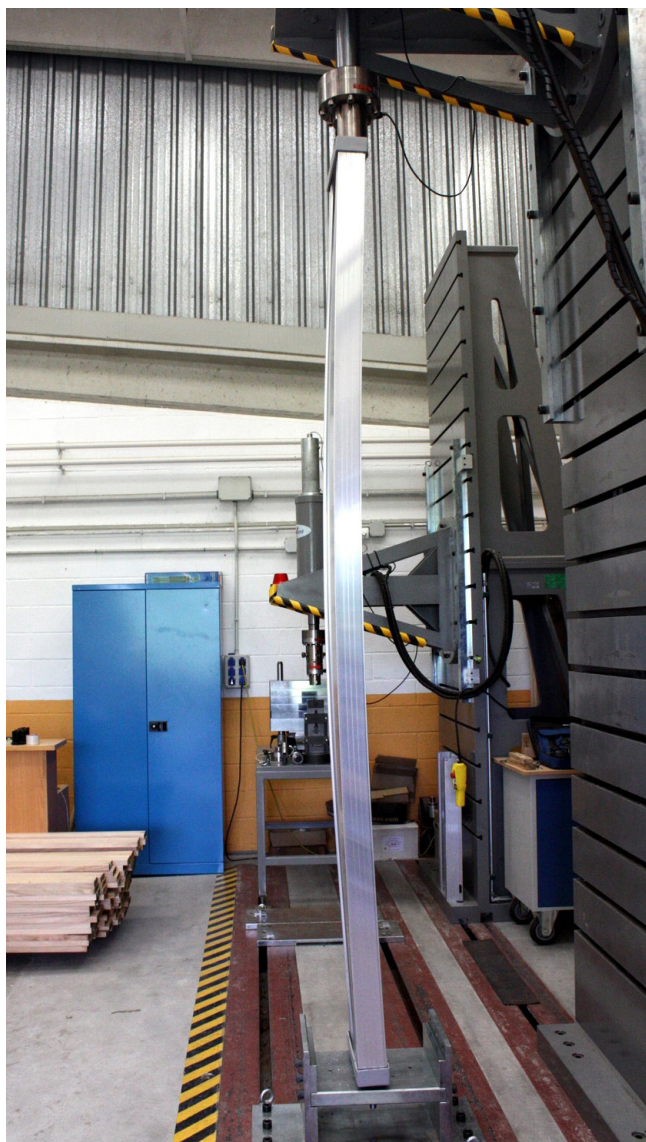
Figura 7. Ensayo a compresión del perfil de aluminio.
