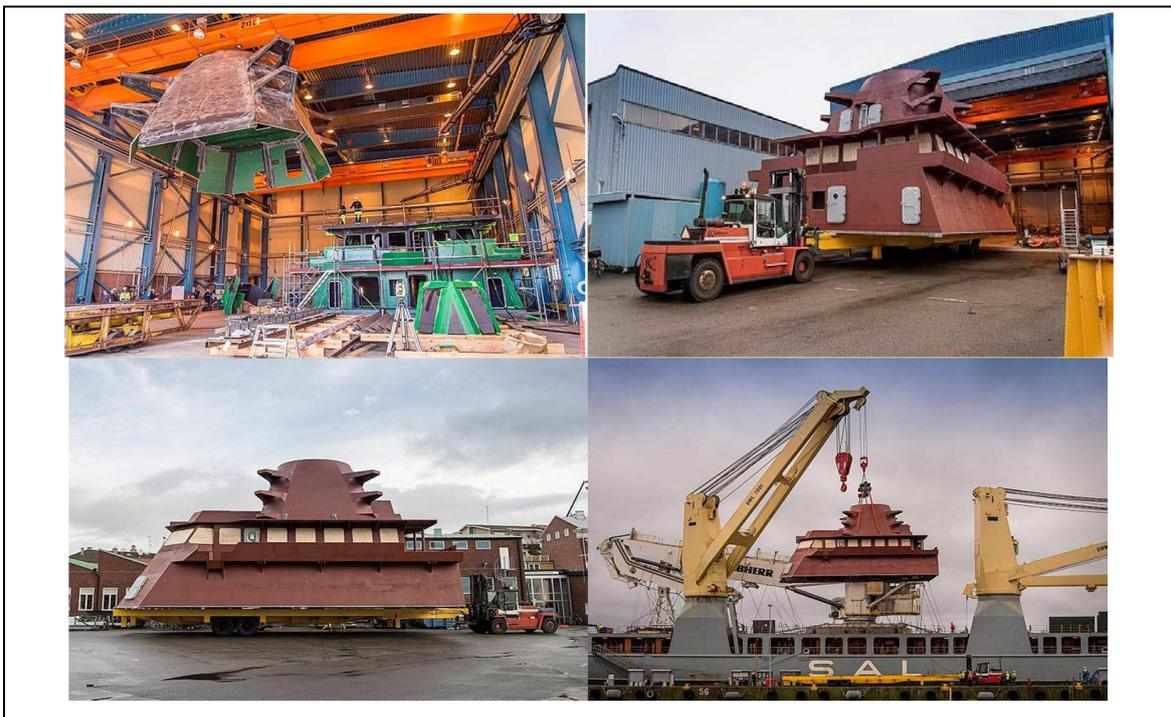
**Figura 10:** Programa LMV (Singapur) - Proceso de montaje: superestructura de 18 m de largo para Fragata [69].
