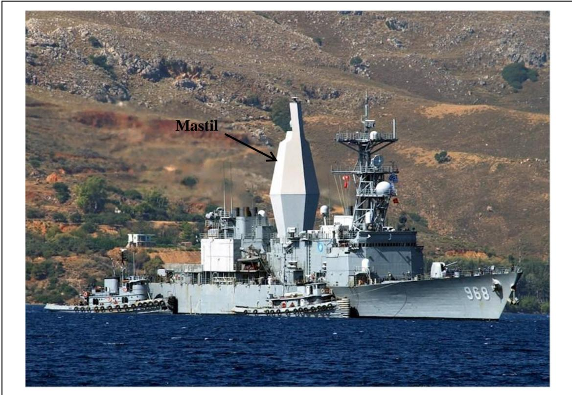
**Figura 14:** Aplicación en mástiles sistema Advanced Enclosed Mast/Sensor (AEM/S): USS Arthur W. Radford, [94]
