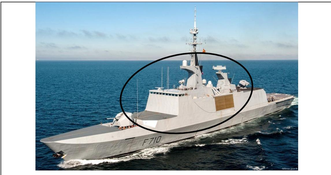
**Figura 12:** Fragata La Fayette con la sección de superestructura compuesta, [104].
