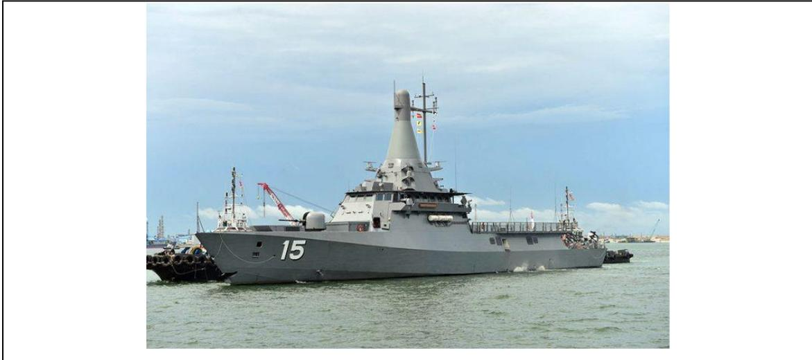
**Figura 9:** Programa LMV (Singapur) - Fragata 15 construida con casco de acero y superestructura CFRP, eslora 80 metros [69].
