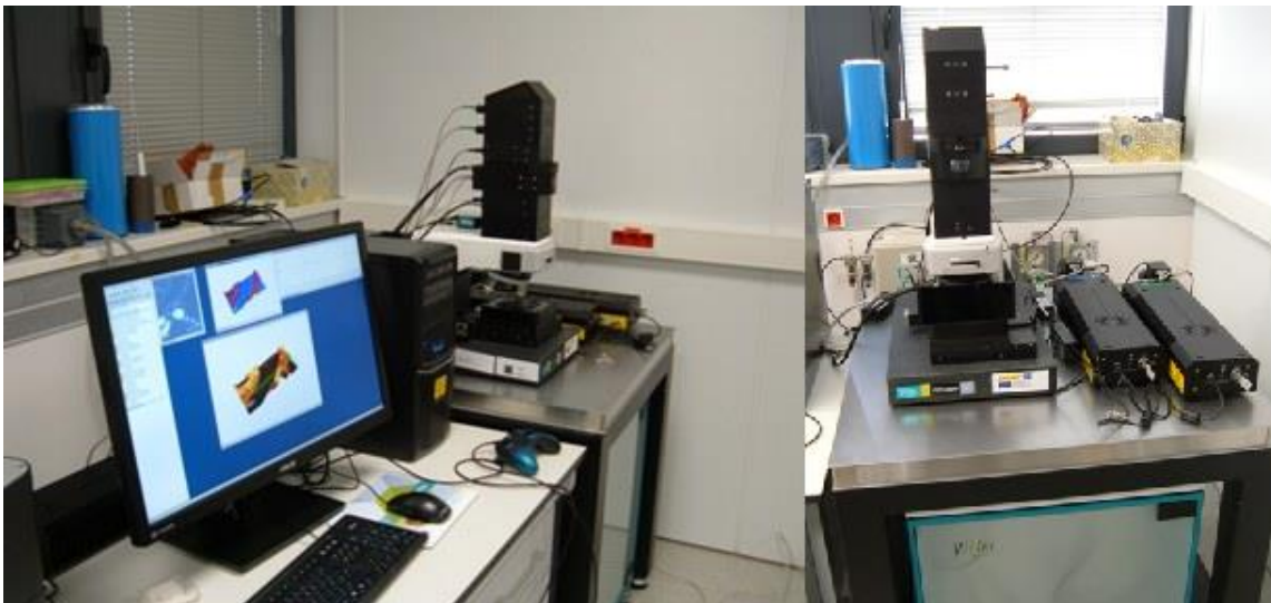
Figura 12. Equipo de espectrometría Raman confocal WITec ALPHA300R+ utilizado en este estudio.
