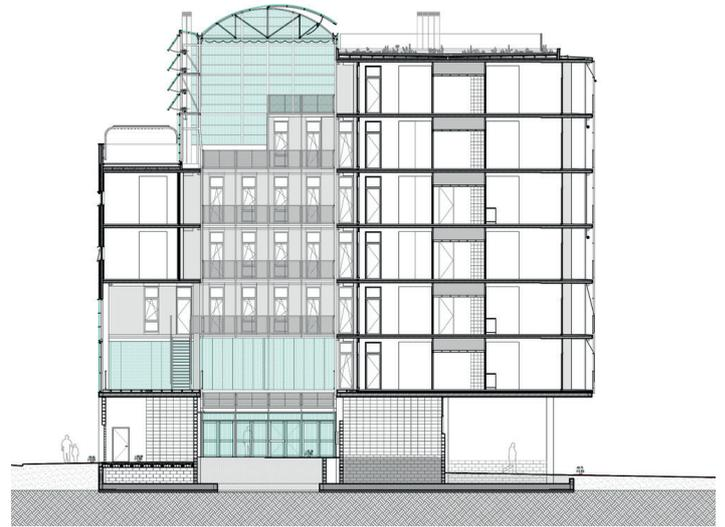
F\_50 Sección Norte-Sur por el patio. En la cubierta del patio se puede apreciar las partes móviles
