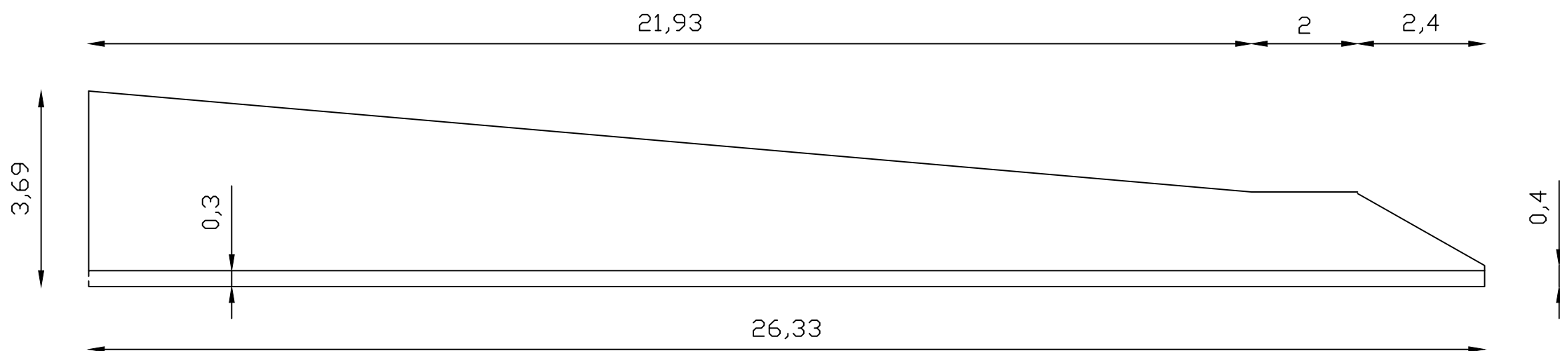
Alzado muro de estribo 2 Escala 1/100
