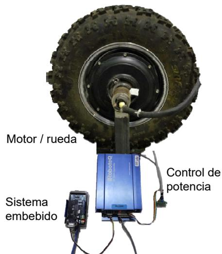
Figura 2: Fotografía del sistema experimental
