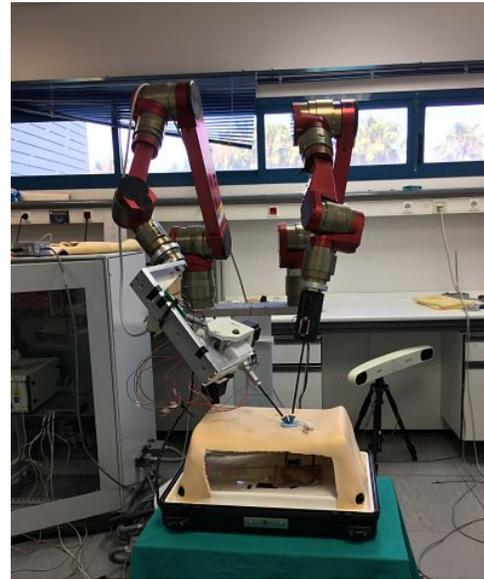
Figura 7: Plataforma CISOBOT dotada del instrumento motorizado.
