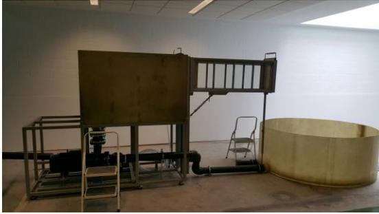
Figura 1(b): Túnel de agua instalado
