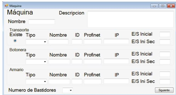
Figura 7 Interfaz de definición de la máquina.
