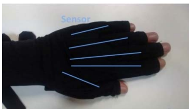
Figura 1: Posición de los sensores en el guante 5DT de 5 sensores.
