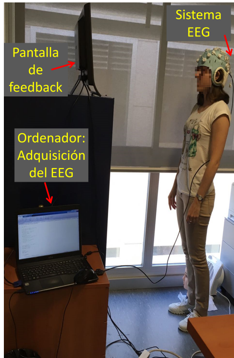
Figura 1: Montaje experimental para la realización del experimento. La pantalla situada enfrente del usuario da instrucciones acerca de la tarea que debe de realizar. Mientras, se están adquiriendo las señales EEG.
