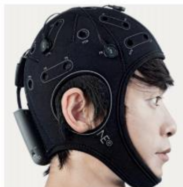
Figura 1: Dispositivo de neuroestimulación tDCS (Neuroelectrics).
