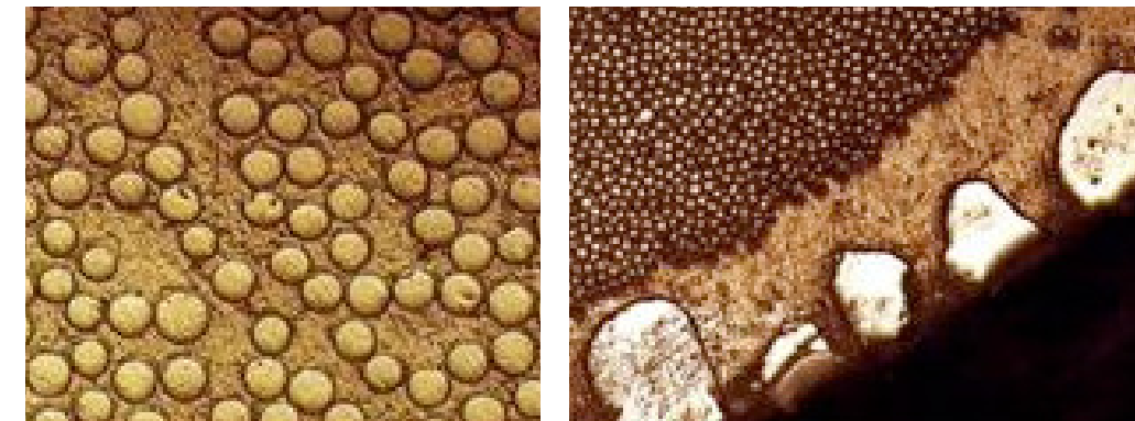
Imágenes de unas barras de GFRP (Aslan) embebidas en una sección de hormigón
