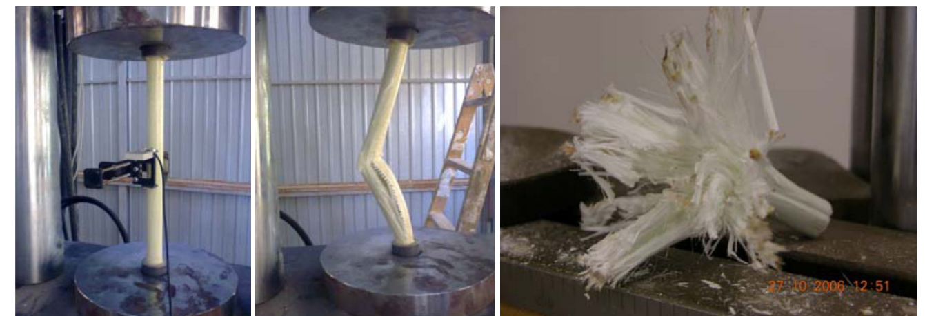
Resultados de ensayo a compresión de barras de GFRP
