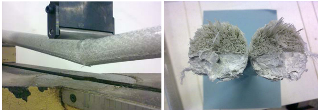
Resultados de ensayo a flexión de GFRP (fibras comprimidas y traccionadas)
