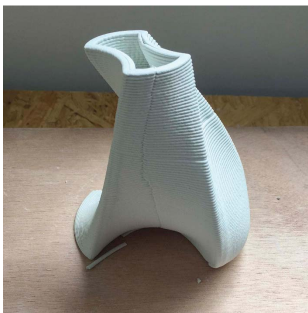
Figura 43- Impresión de Porcelana-1-auga-etanol
