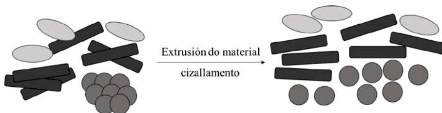
Figura 8- Esquema do aliñamento das partículas antes e despois de ser extruídas
