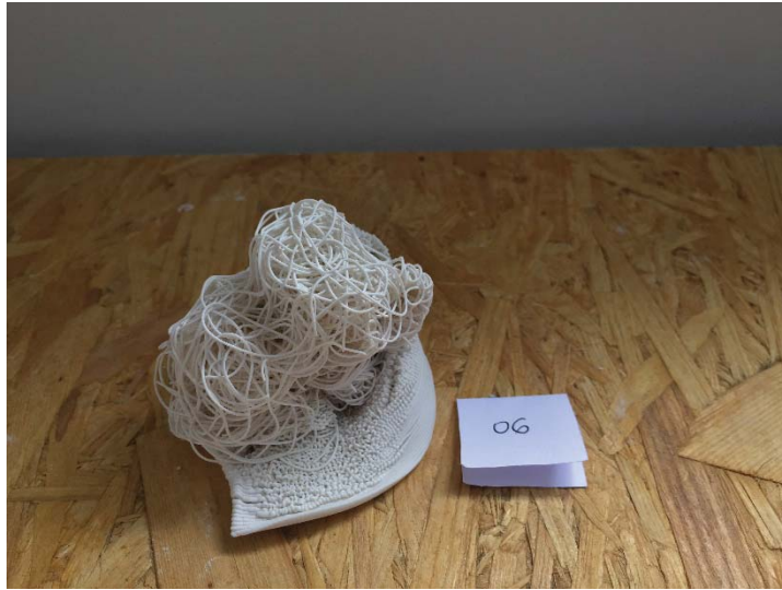
Figura 41- Figura impresa a partir de porcelana-auga-silicato sódico
