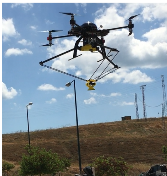
Figura 1: Manipulador aéreo con un sensor. El manipulador es un brazo de tres grados de libertad tipo delta adaptado a un octocóptero de Atyges.
