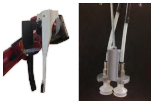
Figura 5: Detalle del sistema de pinza por apriete (izquierda) y del sistema de succión (derecha).
