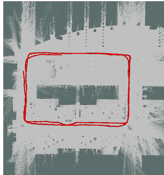
Figura 6: En la línea roja se muestra la trayectoria calculada utilizando el algoritmo de SLAM gmaping . El mapa mostrado en el fondo es el mapa del entorno obtenido a través del mismo algoritmo.
