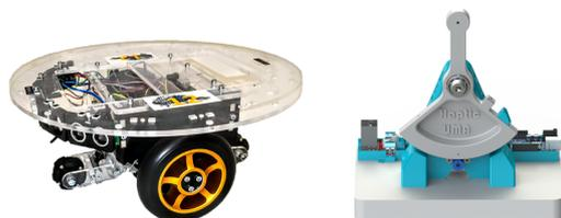
Figura 1: Dispositivos desarrollados para las clases: plataforma robótica móvil PIERO (4ª versión) y el UMA Haptic
