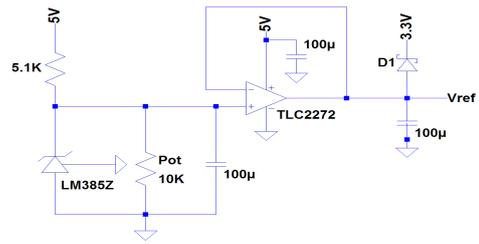
Figura 16: Circuito para obtener la referencia de tensión.
