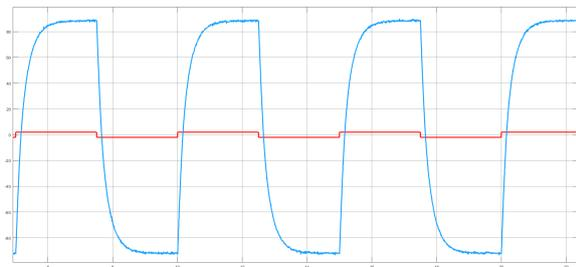
Figura 18: Respuesta temporal experimental en lazo abierto.
