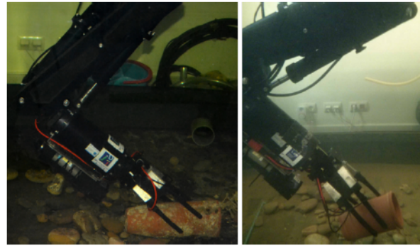
Figura 7: Experimentos de ejecución de la manipulación sobre dos objetos cilíndricos.
