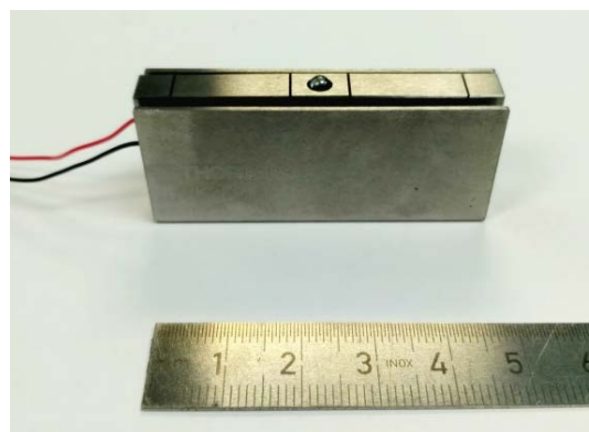
Figura 1: Aspecto de un actuador piezoeléctrico amplificado con carcasa protectora
