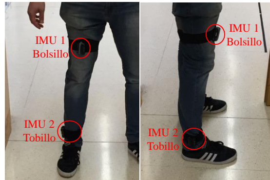
Figura 1: Localización corporal de las IMUs, en el bolsillo y en el tobillo.
