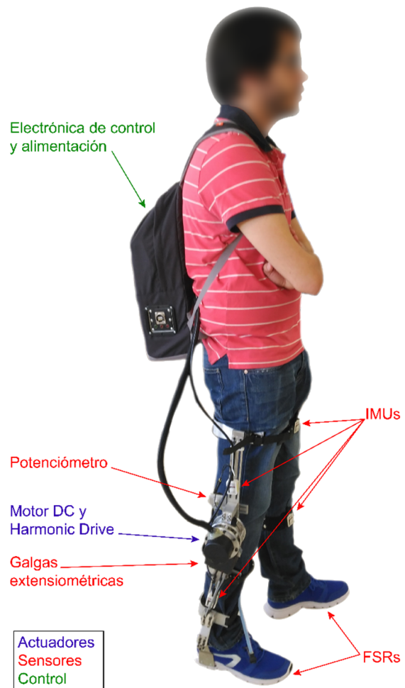
Figura 1: Exoesqueleto monoarticular de rodilla diseñado para la evaluación de algoritmos de asistencia en pacientes hemiparéticos. En la figura se han destacado los sensores y el actuador con los que cuenta el dispositivo. Su sistema electrónico de control y alimentación se encuentra en la mochila que el usuario porta a la espalda.
