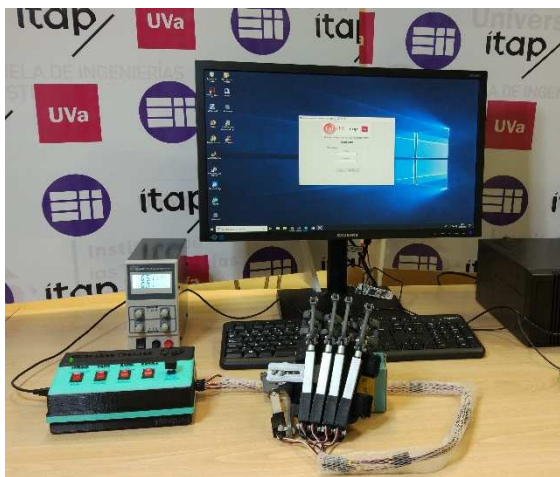
Figura 1: Componentes del sistema Robhand para rehabilitación de mano.
